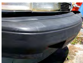
Paraurti di plastica ad alta resistenza
