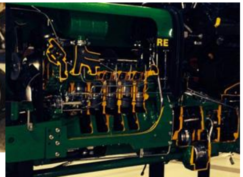
Sezione di motore diesel a 12 cilindri per applicazione ferroviaria e agricola
