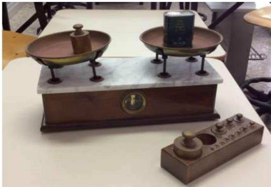
**Figura 18:** bilancia a due piatti per poter calcolare la massa di un corpo
