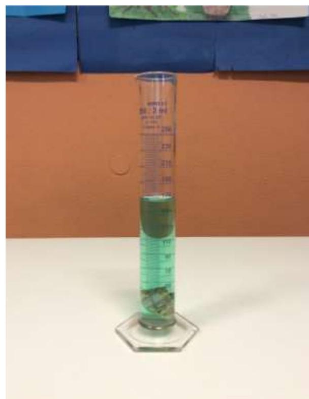
**Figure 6 -7:** usiamo il cilindro graduato per misurare il volume di un oggetto di forma irregolare
